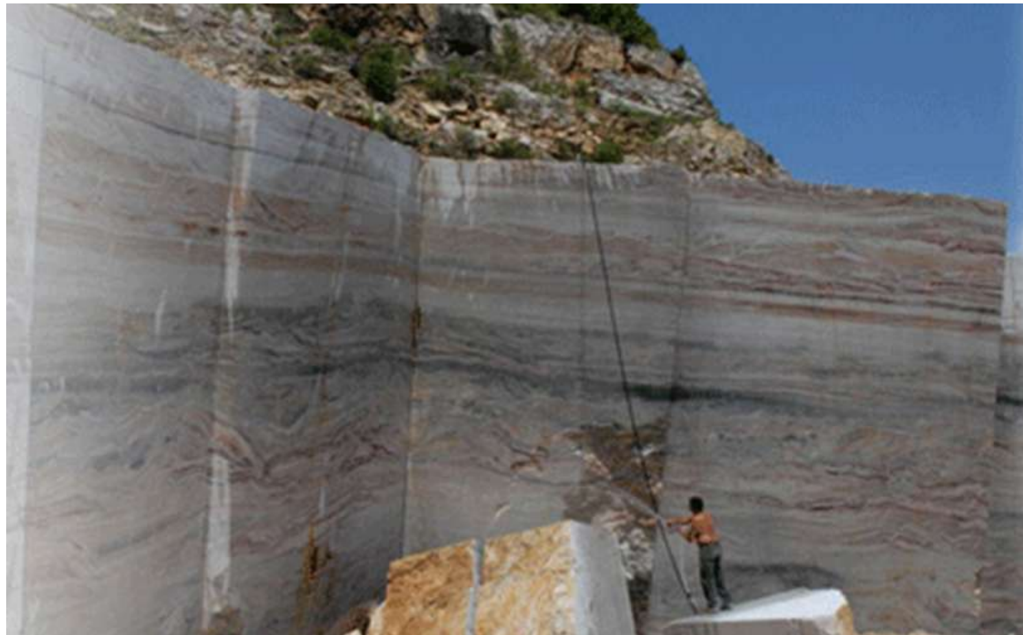
Figura 6 - Ripresa delle bancate plurimetriche sul fronte di cava di Camerata Cornello in località Cespedosio (immagine tratta da sito Web di Cave Gamba sas - https://www.cavegamba.it )
